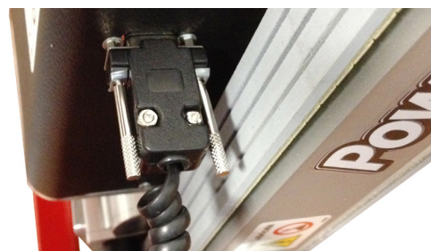
Figura 12 - Connessione cavo all'alloggiamento motore
